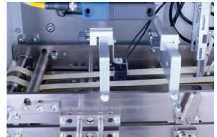
Option: Glanzsensor für Etiketten-Anwesenheitskontrolle und Auswurfweiche zur Ausschleusung fehlerhafter Produkte.
